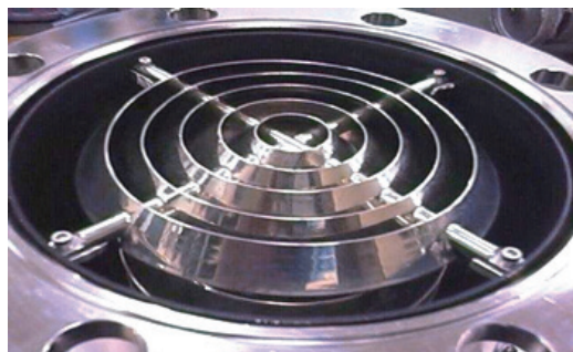
クライオポンプオーバーホール後
