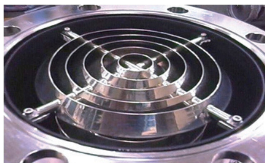
クライオポンプオーバーホール後
